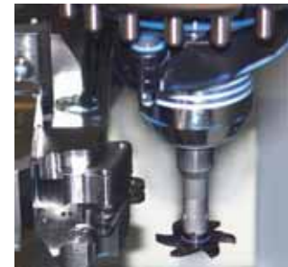
Photo en haut : Les gorges sont fraisées dans les deux pièces à bec avec la fraise à gorges 636.
